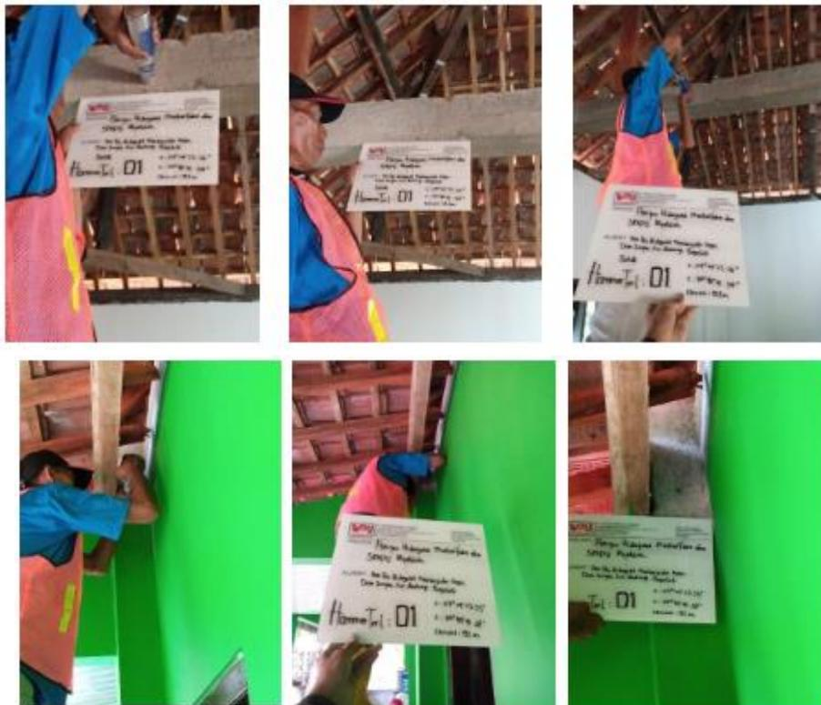
**Gambar 6.** Pengujian *Hammer Test* pada Kolom dan Balok
